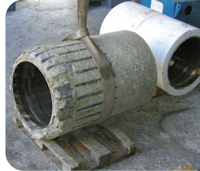
Yeni ön parça (1200mm uzunluğunda) resimde ön tarafta görülen aşınmış tüp kılıfı ile değiştiriliyor.
